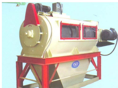
Máy sàng ly tâm Centrifugal Sifter Type Horizontal
