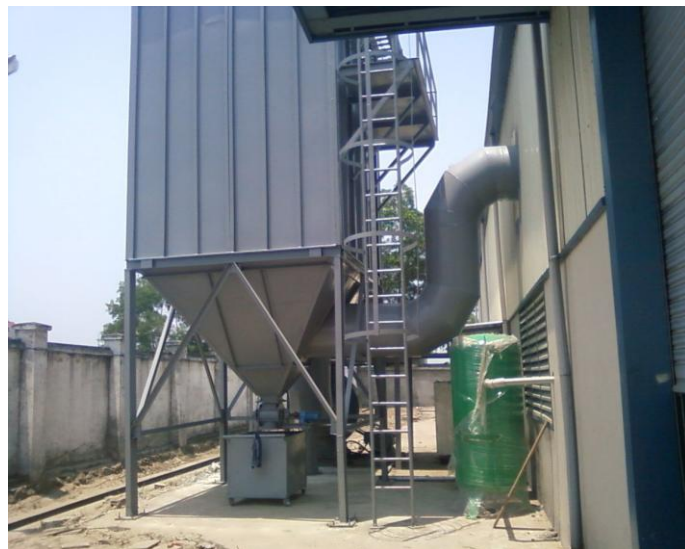
Hệ thống lọc bụi túi vải rung giữ khí nén
